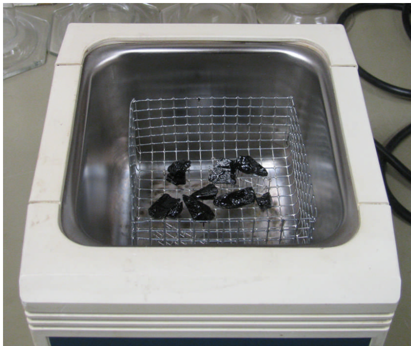
Mynd 2.2. Úthljóðsbað ásamt vírkörfu og nokkrum bindiefnisþöktum steinum. Á myndinni er ekkert vatn í baðinu.
